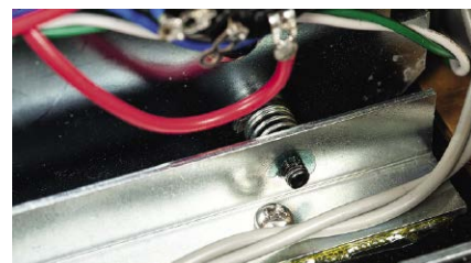
Główną płytę „podwieszono” na sprężynowych tłumikach drgań.
